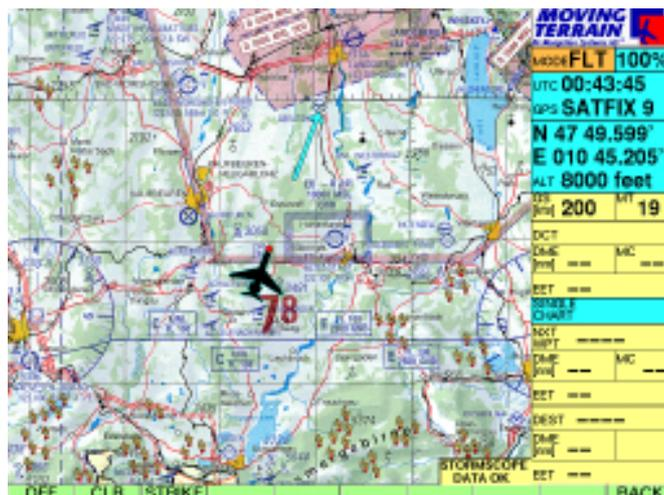
Im Cell Mode wird angezeigt, wo die Logik des WX-500 aus den bisher gewonnenen Daten, Gewitterzellen vermutet. Dieser Cell Mode ist außerdem sehr nützlich während einer Phase heftiger elektrischer Aktivität in der Luft, da dort nicht alle vereinzelt Blitzschläge angezeigt werden, sondern nur die vermuteten Gewitterzellen.
