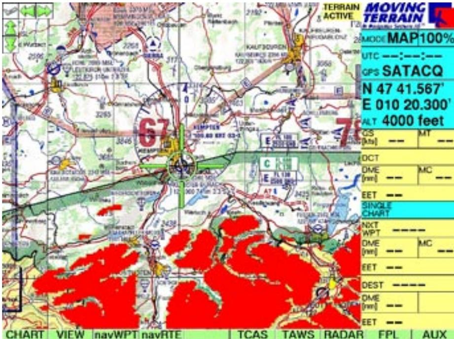
Die Darstellung erfolgt als Layer über der Karte in Bezug zur aktuellen (simulierten) Höhe. Über die Tasten
