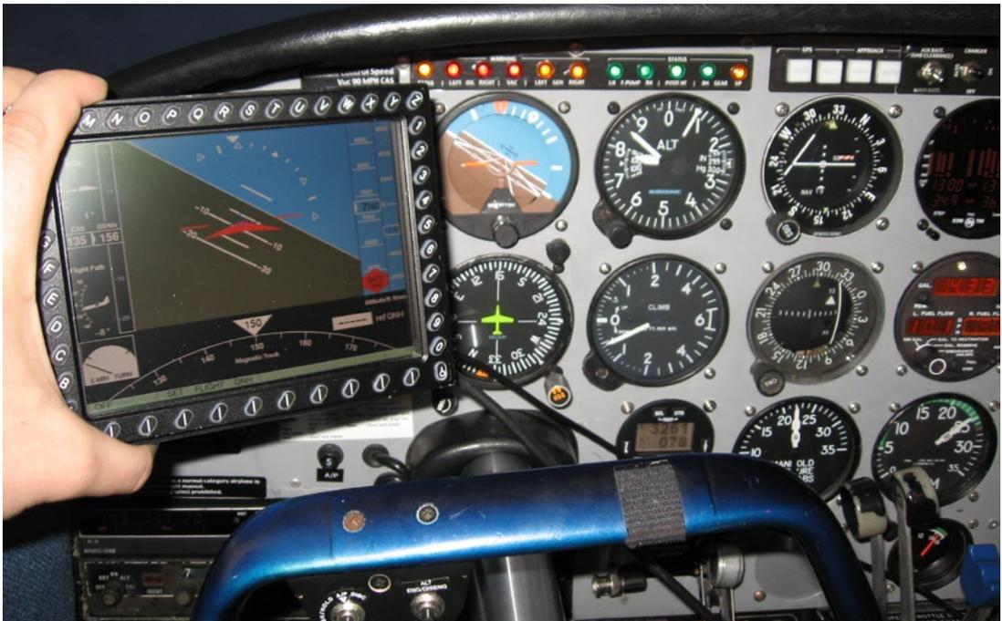
**Praxistest: Airwork in IMC und der direkte Vergleich zwischen MT EFIS und den Kreiselinstrumenten der Twin Comanche. Ergebnis: Das Flugzeug lässt sich nach dem EFIS problemlos steuern. Die Genauigkeit der Calibrated Airspeed (CAS) ist natürlich von der Richtigkeit des Windes abhängig, aber auch ohne Windeingabe liefert das EFIS im Notfall brauchbare Daten, um „greasy side up“ zu bleiben.**
