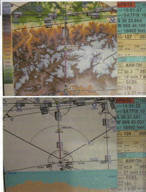
Überflug der Anden auf dem Weg von Buenos Aires nach Santiago de Chile. Auf dem Airway in FL180 (MEA) ist man keineswegs über den höchsten Gipfeln links und rechts. Das VisionAir mit absolutem und relativem Terrain-Layer (TWAS) wird in dieser Situation zum äußerst nützlichen Werkzeug.
