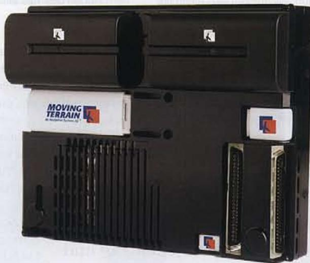
Auf der Rückseite des Vision Air X werden die wesentlichen Neuerungen bei der Hardware sichtbar. Zwei Akkus versorgen das Gerät. Sie können (nacheinander) im Betrieb gewechselt werden. Das Datenmodul ist als UMTS-USB-Stick angelegt und kann leicht getauscht werden, ebenso wie der externe USB-Speicherstick. Ein internes GPS sorgt dafür, dass das Gerät sofort nutzbar ist.
