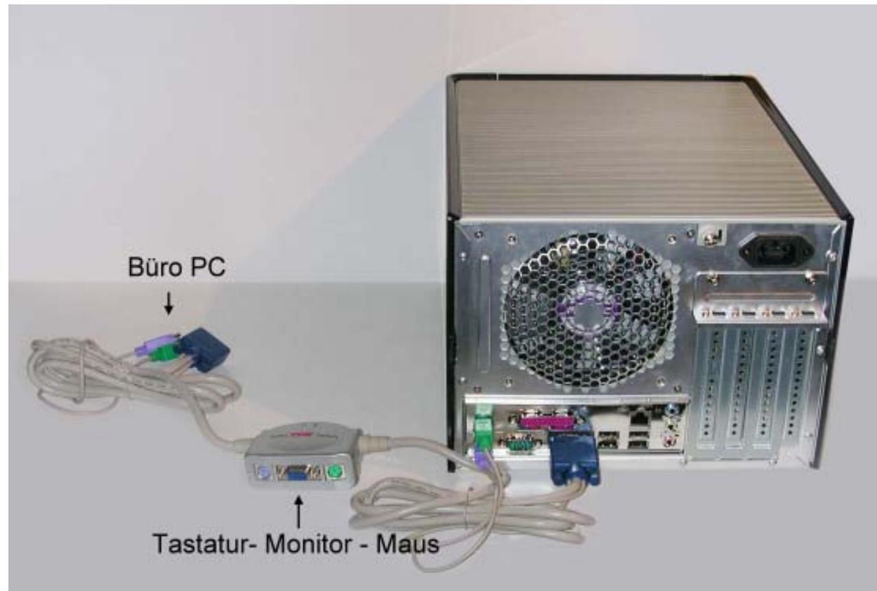
Bild 1 . Anschluß des EFB Update Systems, Umschaltbox (Mitte) und Büro PC
