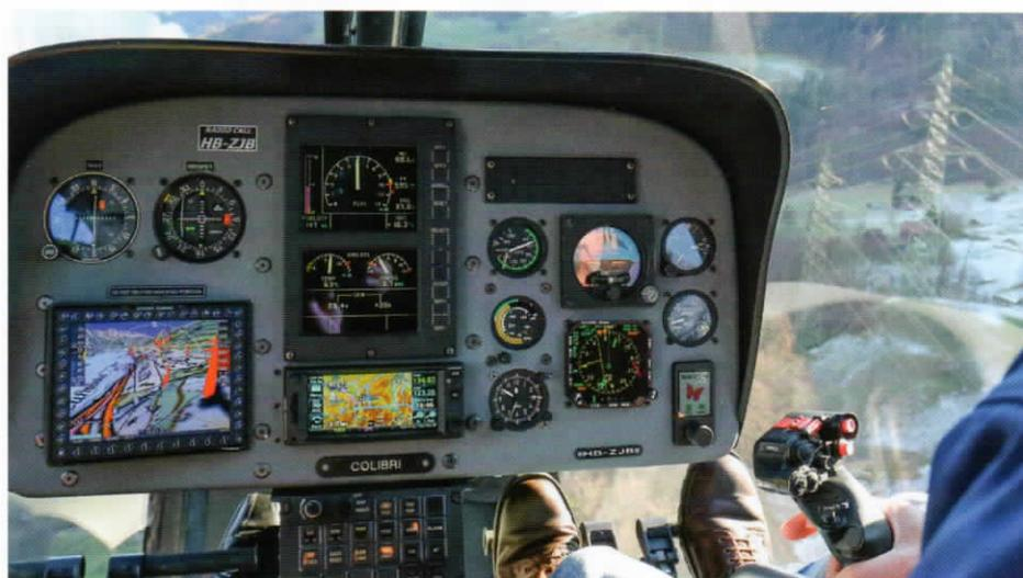
Ein starkes Safety-Element: Die laufend aktualisierte Hindernisdatenbank zeigt Hindernisse wie Kabel und Masten in warnenden Farben: Der Mast rechts im Gelände ist auf dem Display am rechten Rand in rot zu sehen.
