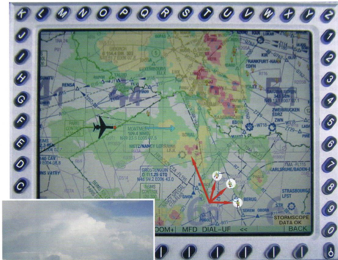
Typische Kombination aus Stormscope und Radar-Uplink. Durch die Überlagerung beider Informationen im Moving Terrain Vision Air wird eine wirklich brauchbare Entscheidungsgrundlage daraus.
