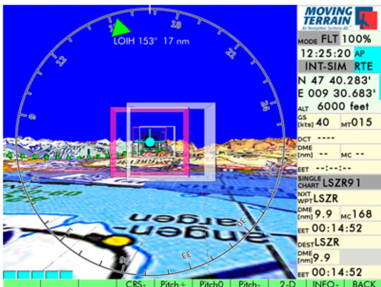
Der **Flight Path Indicator** nimmt die Position bezogen auf 10 Sekunden Weiterflug vorweg. Das stilisierte Flugzeugsymbol ermöglicht die gewünschte Flugroute exakt zu verfolgen und Windeinflüsse oder Korrekturen unmittelbar einzuschätzen.
