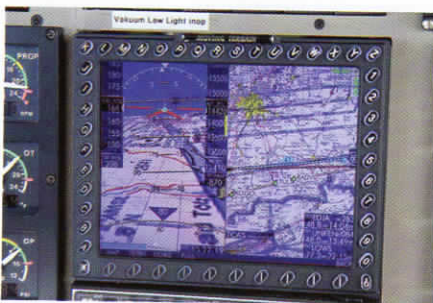
Hohe Informationsdichte. Eine Splitscreen-Darstellung ermöglicht die gleichzeitige Darstellung von 3D-Geländemodell und 2D-Kartenansicht.
