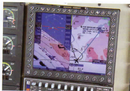
Vollwertiges EFIS mit Geländedarstellung (links), Kartendarstellung (rechts). Kritische Geländebereiche werden eingefärbt.
